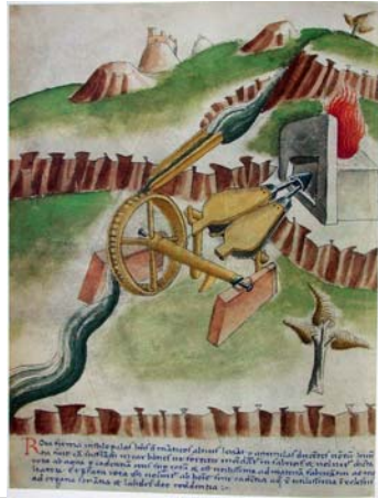
Figura 1: una ruota idraulica aziona un mantice (Taccola, ca. 1450)
