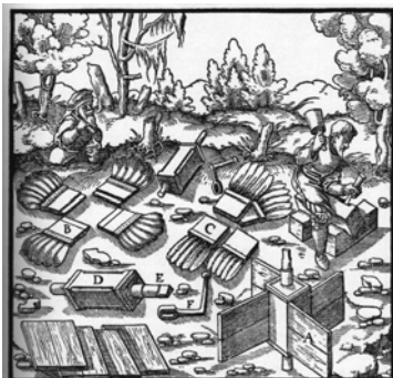
Figura 3: Ventilatore scomposto nelle sue parti (Agricola, De re Metallica , 1556)
